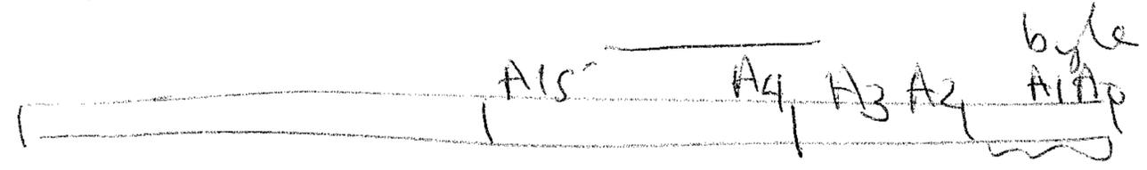
byte select =  $\log_2 4 \text{ byte} = 2 \text{ bits}$
